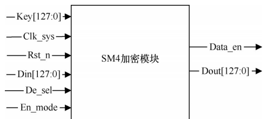
图 8 SM4 加密模块顶层设计
